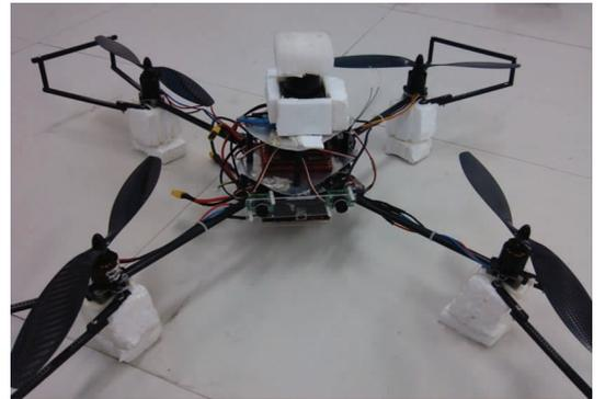
图7 搭载双目立体视觉平台的微型无人机平台
