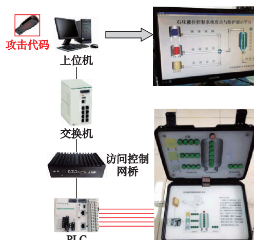
图 15 石化液位控制系统攻击与防护演示平台
