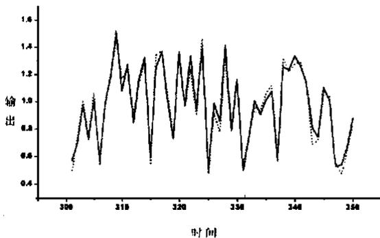
图1 系统的实际输出(实线)和一步前预测输出(点线)
