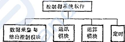
图 4 控制器系统软件组成框图
